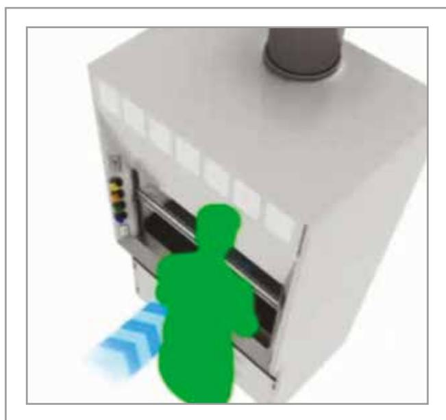
5. **Mantener la cabeza vertical frente a la guillotina. La guillotina es la protección principal en caso de explosión accidental o de fugas de líquido o gases.**
