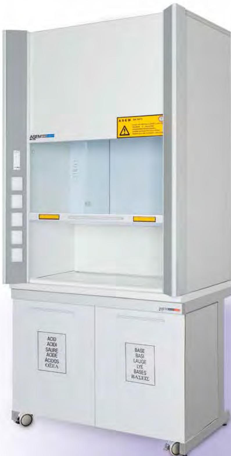
Vitrinas de gases certificadas EN 14175 disponibles en 3 modelos diferentes: Clase "0" con estructura metálica revestida con pintura epoxi antiácido; Clase "1" fabricadas con paneles de aglomerado hidrófugo revestido con laminado plástico ignífugo o modelo apto para ácidos agresivos fabricado con la cámara de aspiración en paneles de polipropileno de grosor 15 mm y ventana guillotina de policarbonato.
